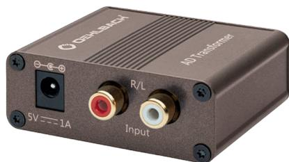
Il trasformatore AD di Oehlbach esegue la conversione di alta qualità di un segnale analogico-elettrico in un segnale digitale. Dopo la conversione, il segnale audio immesso tramite cinch stereo può essere emesso tramite l'uscita digitale-coassiale o tramite l'interfaccia ottica TOSLINK; la frequenza di campionamento è di 96 kHz. La conversione A/D di alta qualità è eseguita da precisi chip Cirrus Logic.
