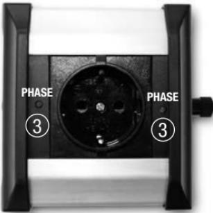
Si tras girar el enchufe 180° se ilumina siempre el mismo LED ③ establezca una conexión con el cable de masa proporcionado entre el PHASER ④ y la masa del aparato a probar. Un punto de masa óptimo es, por ejemplo, el contacto exterior de un conector cinch.
