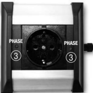
Zou ook na het 180 graden draaien van de stekker dezelfde LED ③ branden, legt u dan een massakabel aan tussen de Phaser ④ en de massa van het te testen apparaat. Een geschikt massapunt is bijvoorbeeld het buitenste contact van een cinchstekker. Daarna herhaalt u de testprocedure en stelt u de juiste fase vast. Uw installatie kan dan op de juiste wijze op de contactdoos aangesloten worden.
