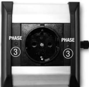
Si après avoir tourné le connecteur à 180° ce sont toujours les mêmes DEL ③ qui s'allument, établissez une liaison avec le câble de masse joint entre le testeur de phase ④ et la masse de l'appareil à tester. Le contact extérieur d'une douille cinch constitué par ex. un point de masse optimal.
